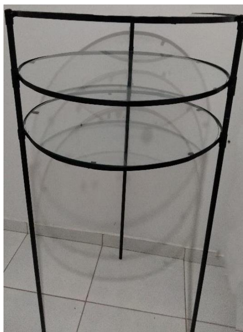
Figura 4: Estrutura metálica completamente montada e com vidros inclusos
