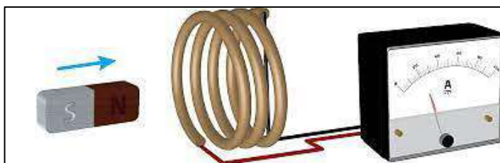
Figura 4: O movimento relativo do ímã na espira indica uma corrente elétrica no amperímetro
