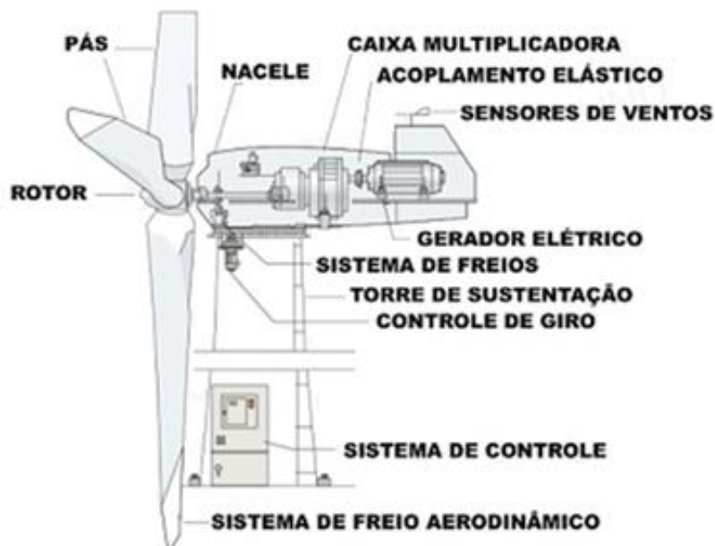
Figura 9-Componetes de Aerogerador
