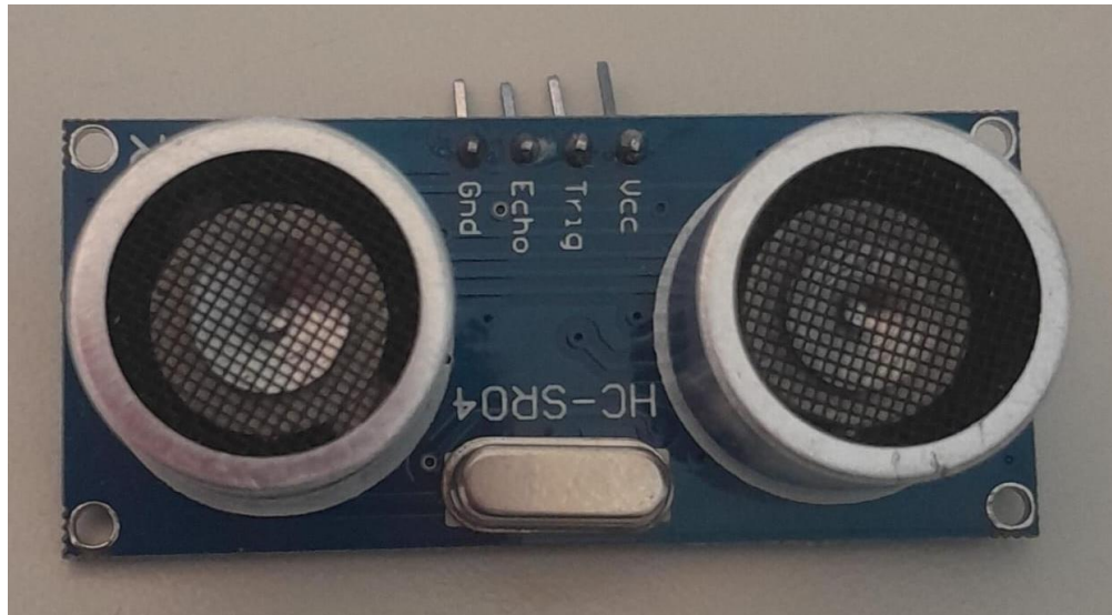
Figura 26: Sensor de distância ultrassônico HC-SR04.
