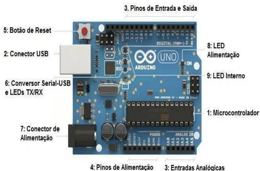
Figura 14: Principais elementos de uma placa Arduino Uno.
