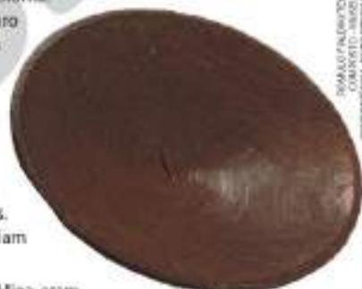
Bateia de madeira utilizada na mineração do ouro no século XVII. A bateia de madeira era um dos equipamentos de mineração utilizados nas aluviões da África, que foi introduzido na colônia pelos africanos.
