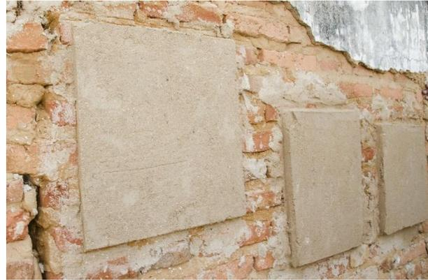
Figura 54 – Argamassa assentada no muro
