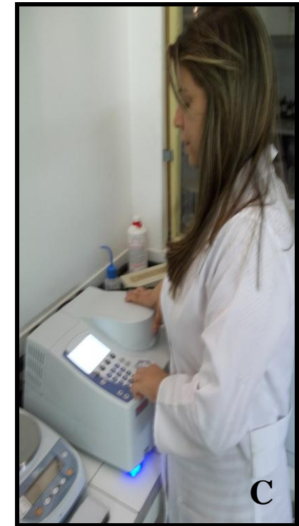
A: Amostras em diversas concentrações; B: Solução de DPPH; C: Leitura em espectrofotômetro. Fonte: Foto da autora.
