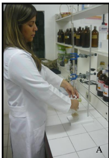
Figura 10 — Determinação da acidez total dos grãos de C. cajan
