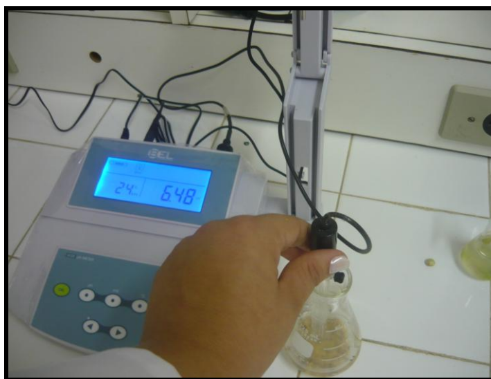
Figura 9 — Determinação do pH dos grãos de C. cajan .
