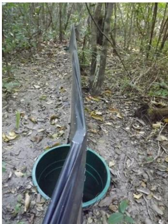
Figura 2: Armadilha de Intercepção e Queda (AIQ). FONTE: OLIVEIRA, H. F.
