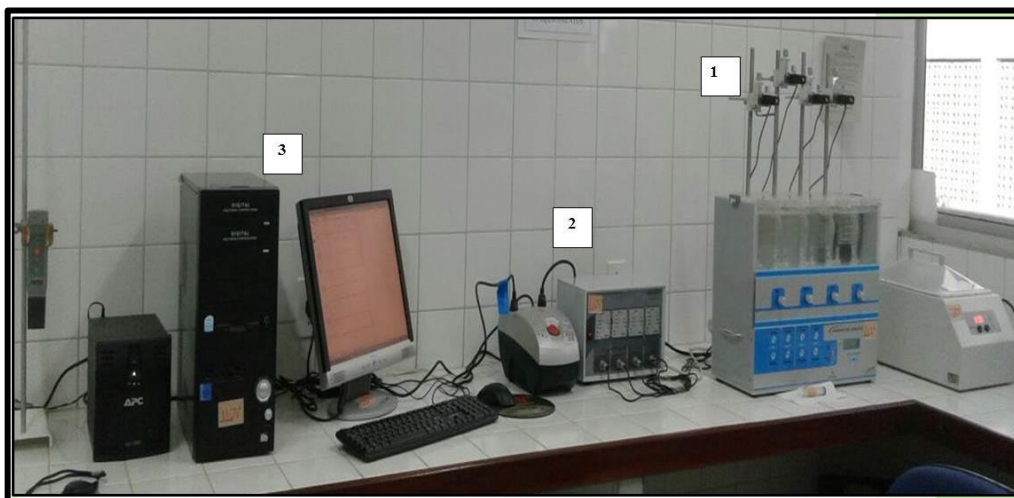
Figura 8 – Imagem ilustrativa do equipamento utilizado para medir a resposta mecânica do músculo liso.
