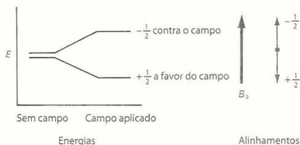
Figura 5: A separação de energia no estado de spin como uma função da intensidade do campo magnético aplicado. Fonte: (GONSALVES, 2007).
