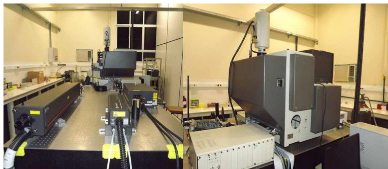
FIGURA 11 – Espectrômetro utilizado nas medidas Raman.
