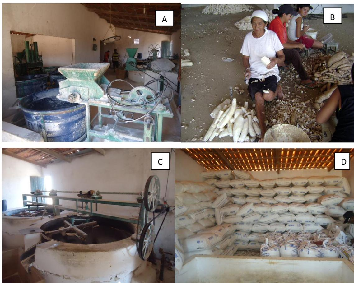
**Figura 7:** Cooperativa para cultivo e produção de farinha de mandioca da comunidade quilombola, Serra dos Chagas, Salitre – CE. A. Máquina de moer mandioca; B. Descascadeiras de mandioca; C. Forno de torrar farinha; D. Farinha pronta para revenda.
