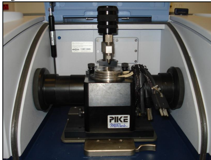
Figura 10 - Porta-amostra para realizar medidas utilizando a técnica de reflexão total atenuada (ATR) na região do Infravermelho
