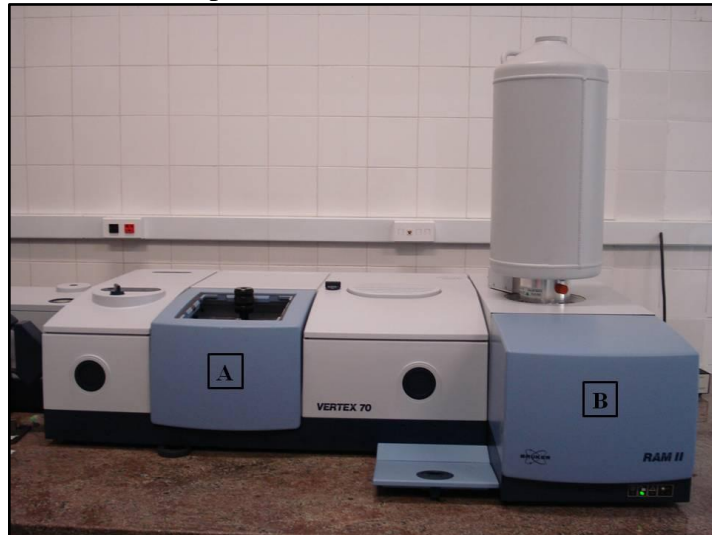
Figura 9- Espectrômetro utilizado para realizar medidas de FT-IR (A) e FT-Raman (B)
