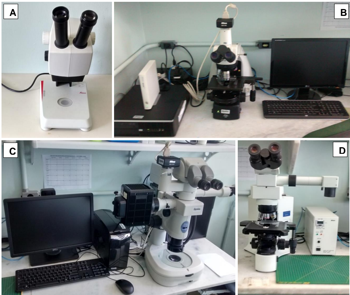
Figura 11 – Aparelhos ópticos utilizados na análise das microestruturas. A: Microscópio estereoscópio. B: microscópio óptico com câmera acoplada. C: Microscópio estereoscópio com câmera acoplada. D: Microscópio de câmera clara. LBF/UFRN. FONTE: Arquivo pessoal, 2014.
