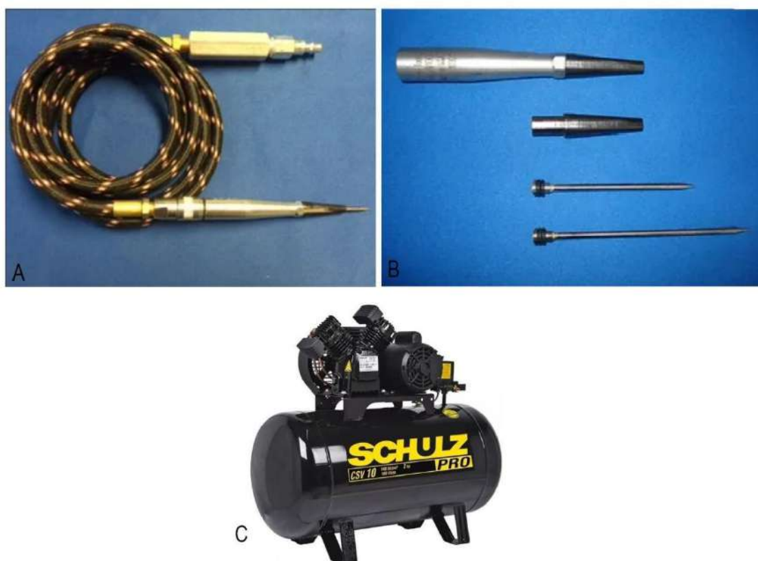
Fig. 14. Equipamento de preparação mecânica utilizado neste trabalho: A - caneta pneumática, B - ponteira de aço; C - motor compressor de ar. (Fonte: paleotools.com/me-9100 ).
