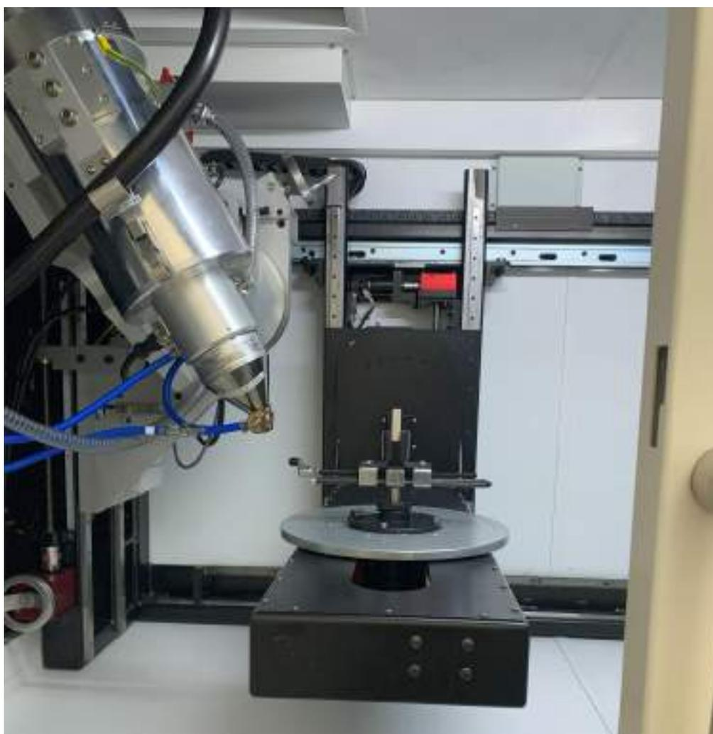
Figura 11: tomógrafo computadorizado de raio X (XT H 225 ST).
