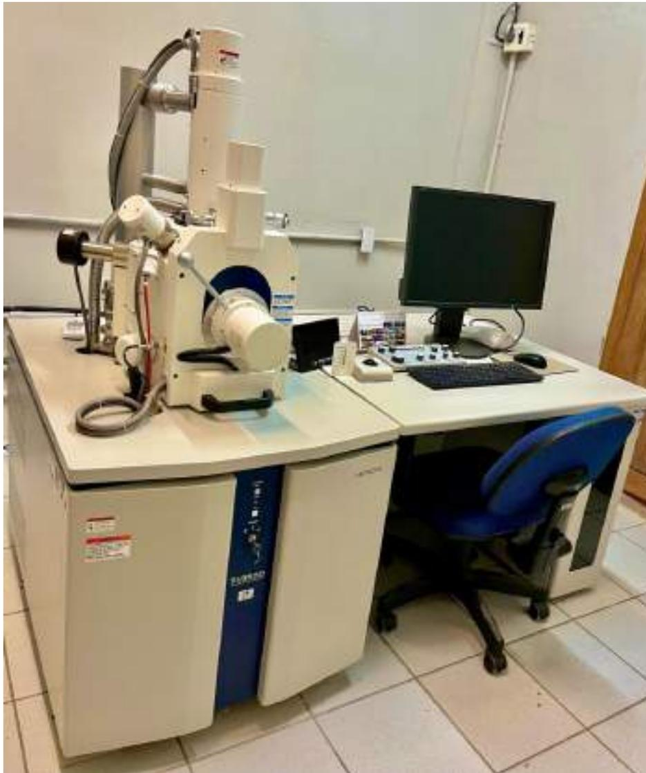
Figura 10: Microscópio Eletrônico de Varredura SU3500 (Hitachi, Tóquio, Japão) utilizado para obtenção das imagens deste estudo. Fonte: URCA.
