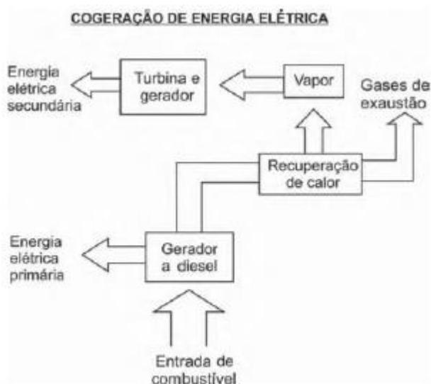
Em relação ao processo secundário de aproveitamento de energia ilustrado na figura, a perda global de energia é reduzida por meio da transformação de energia
