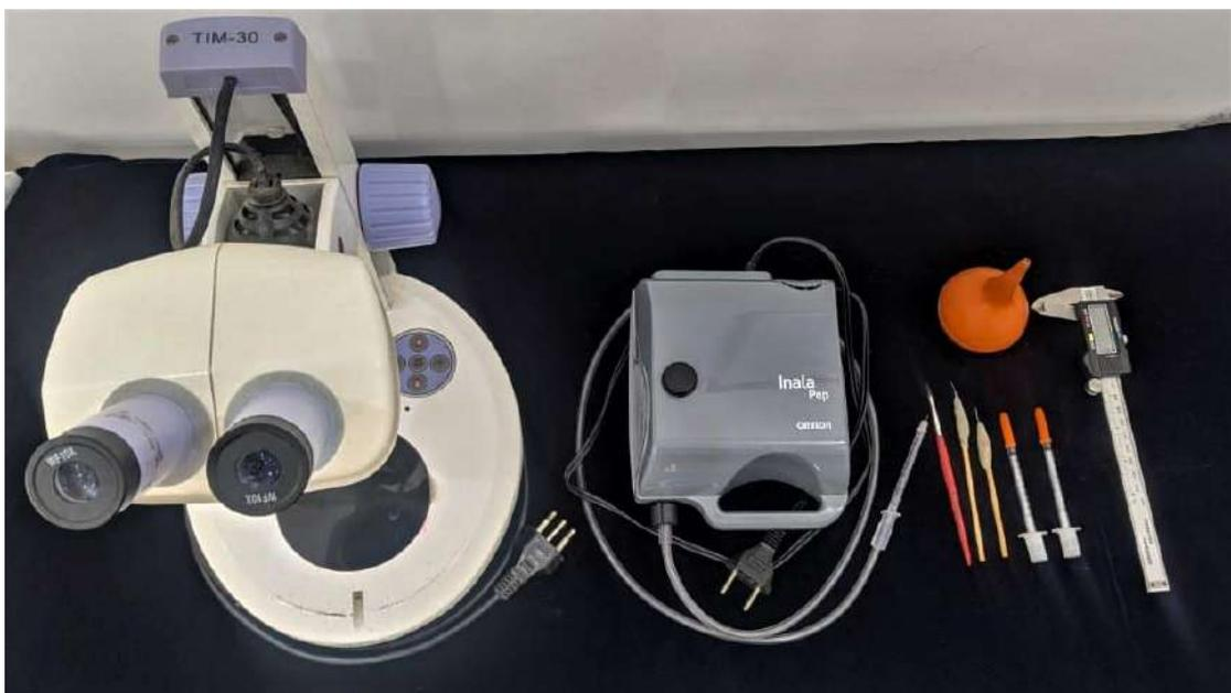
**Figura 6** - Lupa estereoscópica, equipamentos de preparação mecânica e paquímetro eletrônico. **Fonte:** autor.
