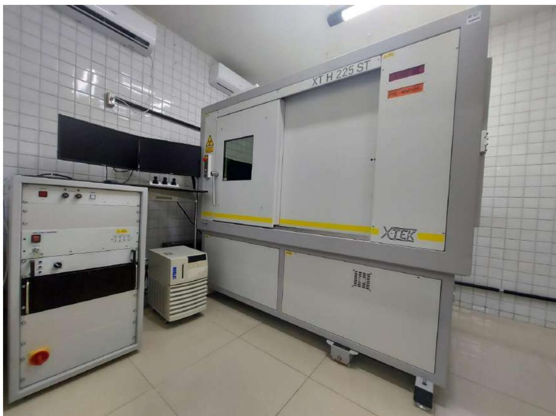
**Figura 8** – Microtomógrafo modelo Nikon XT H 225 ST. **Fonte:** autor.
