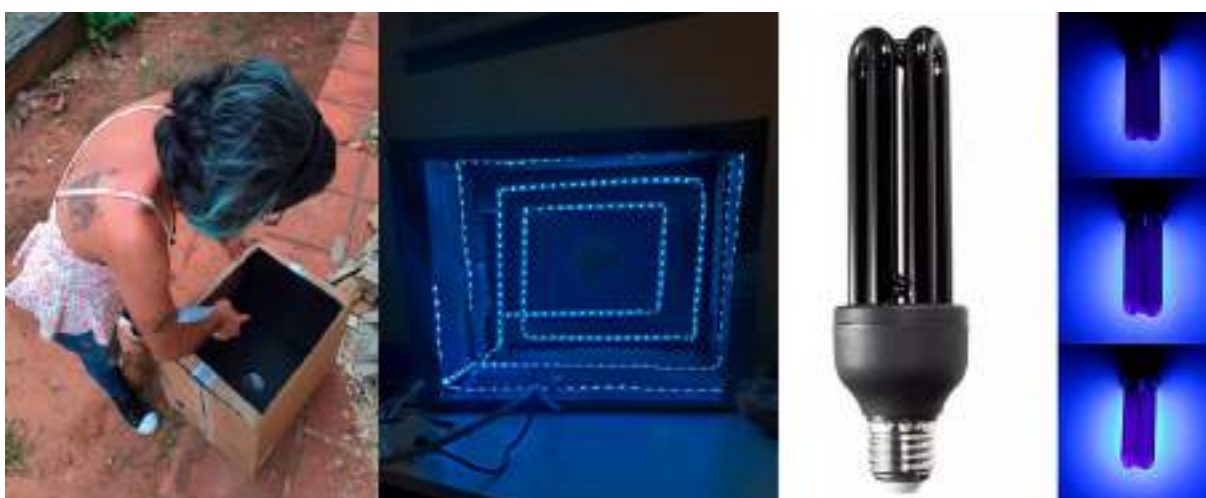
Figura 28. Construção da câmara escura e disposição das luzes.
