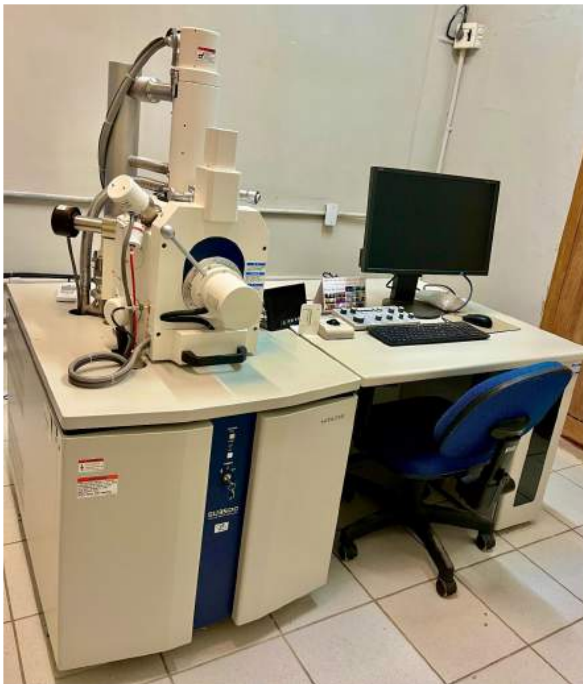
Figura 18. Microscópio Eletrônico de Varredura (MEV), adquirido com apoio da Financiadora de Estudos e Projetos (Finep). Fonte: URCA
